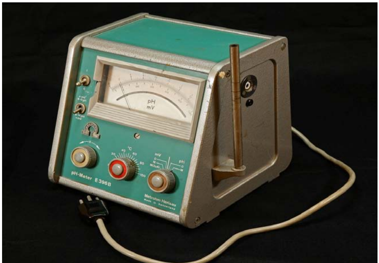
Neuzugang: pH-Meter "Modell E 396B", hergestellt von Metrohm AG, Herisau, um 1960. Im Einsatz stand er in der Kantonsschule Rämibühl in Zürich.
